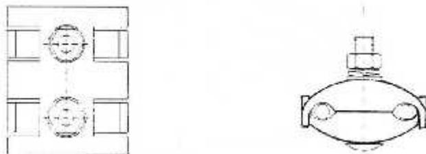
Para la selección del rango del conector, se deberá considerar que el mismo será instalado sobre las varillas de armar del cable OPGW de un lado y del otro lado, al conductor de puesta a tierra bajante tipo AAC No. 9 AWG.
